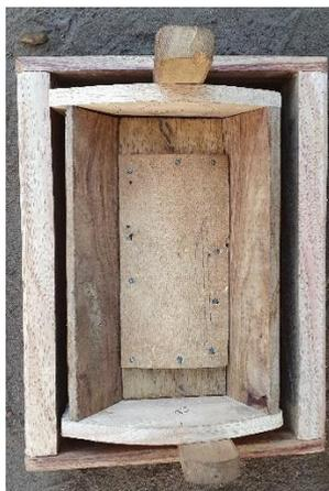
*Mit der Schalung aus Holz werden die 6 Segmente geformt. Der Boden wird in den Kocher gelegt, die Segmente werden anschließend mit 2 Ringen aus Metall festgemacht.*
