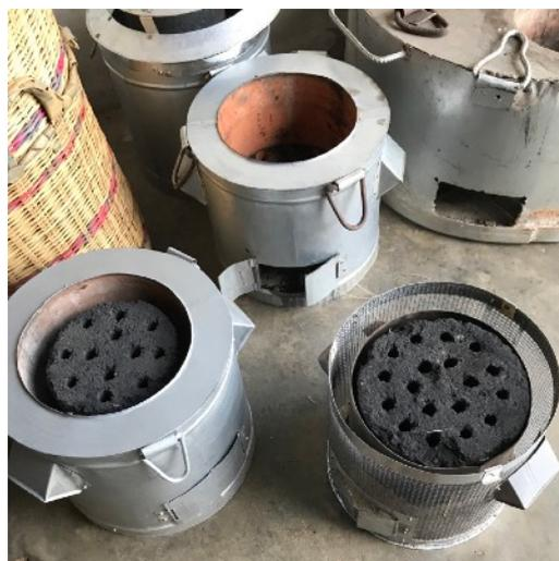
Beispiel Bananenschalen - im werkseigenen Meiler karbonisiert. Diese Abfälle werden von in der Nähe ansässigen Müllsammlern aber auch von Großküchen angeliefert. Für die stangenförmigen Briketts ist eine in Uganda (nicht China) gefertigte Brikettmaschine angeschafft worden, die mit 230 Volt Wechselstrom betrieben wird. Die Honeycomb-Briketts werden hingegen paarweise manuell gepresst. Im Bild links sind ein niedriges und ein hohes Honeycomb-Brikett in jeweils einem Holzkohle-Kocher zu sehen.
