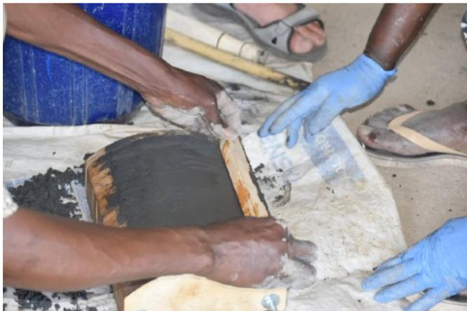
Bild links: Lehmkocher-Fertigung in Kenia. Die Lehm-Mischung wird in eine mitgebrachten Form gestampft und glattgestrichen. Nach 6 Stunden wird das Segment aus der Form entnommen, damit es noch etwa eine Woche trocknen kann. Die Arbeiter tragen Gummihandschuhe, weil der Zement in der Mischung ätzend ist.
