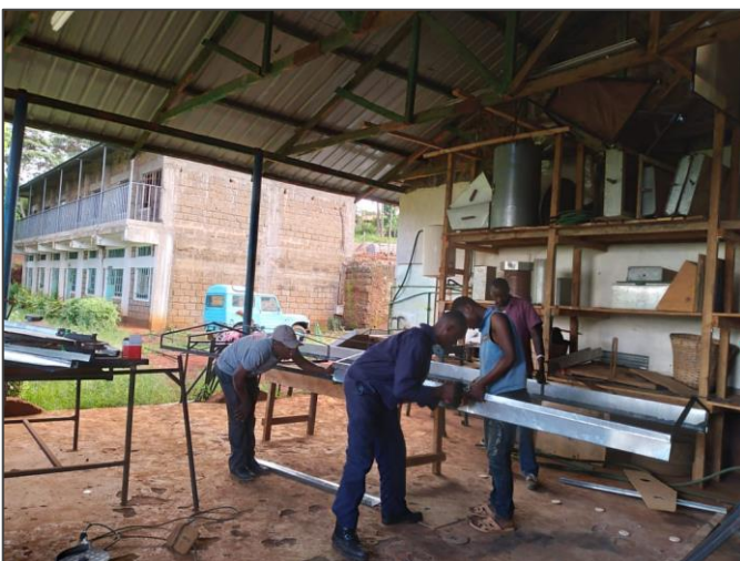
Unter Mwanikis fachkundiger Anleitung werden die Trockner gebaut.
