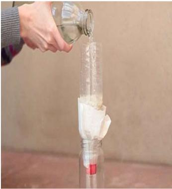
Une première étape importante. En filtrant de l'eau boueuse ou d'apparence sale à l'aide d'un morceau de tissu de coton fin et propre, on éliminera souvent une partie des solides en suspension et des larves d'insectes contenus dans l'eau.
